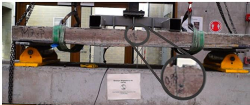
Figura 7. Estado probeta 7 grupo P previo al ensayo. Se identificaron algunas fisuras iniciales.
