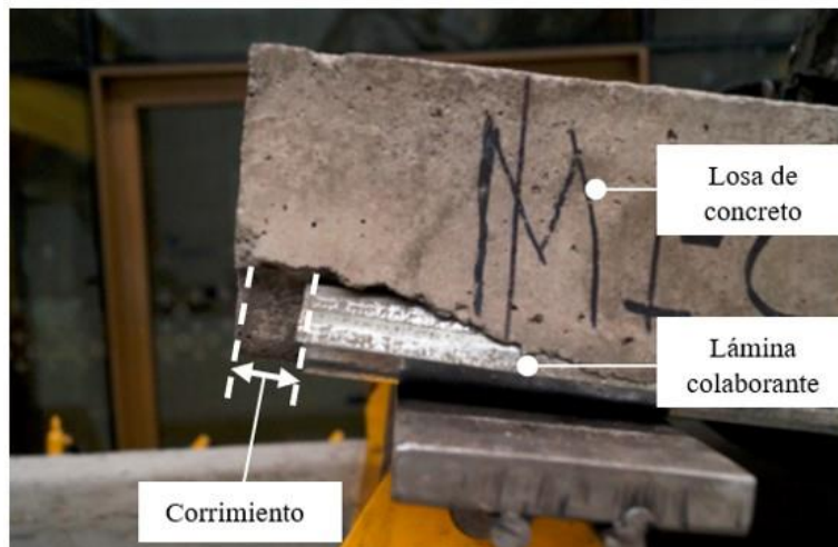
Figura 12. Deslizamiento o corrimiento longitudinal probeta grupo C
