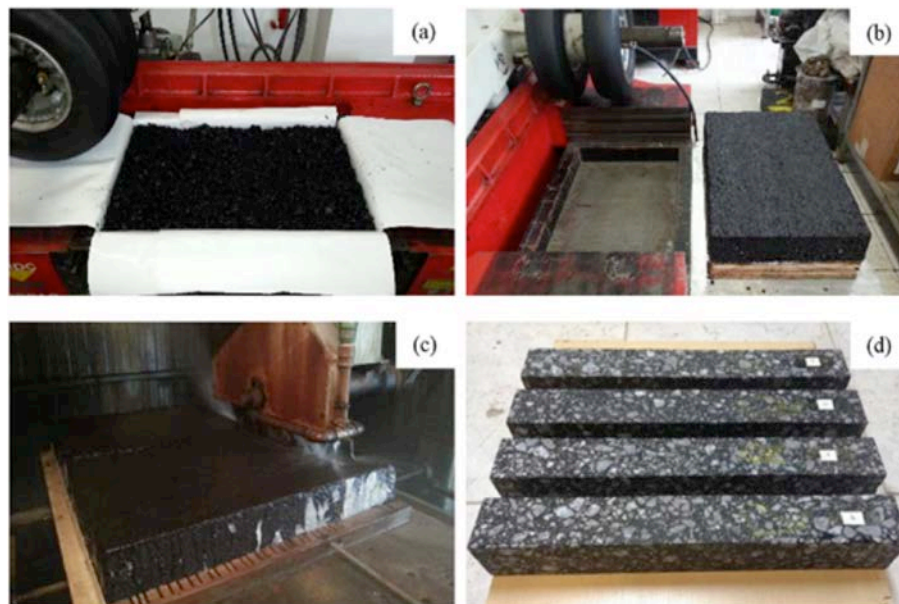
Figura 1. Procedimiento para la compactación de las placas y extracción de las probetas: (a) compactación, (b) placa compactada, (c) corte de la placa e (d) probetas prismáticas extraídas
