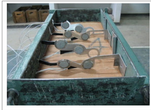
Figura 2. Posición de los sensores para la medición del transporte de agua Figure 2. Arrangement of Sensors for measuring water transportation
