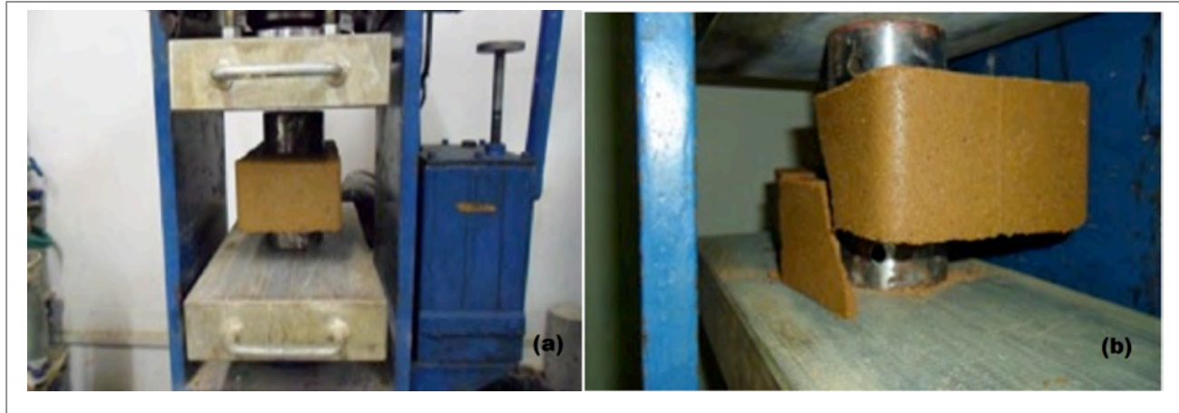
Figura 4. Ruptura de bloques
